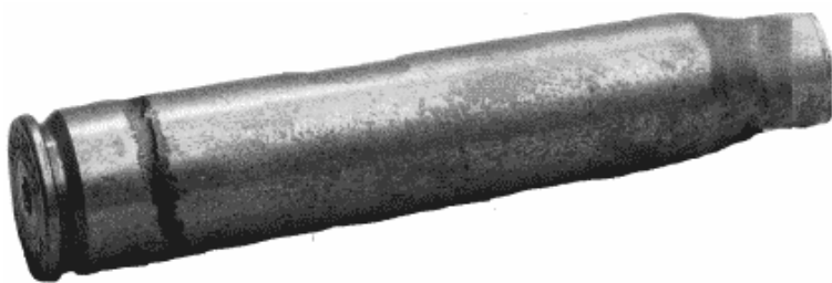
Tipica rottura per eccessivo spazio di testa
